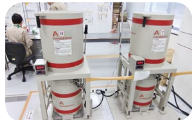
放射性物質を検査するゲルマニウム半導体検出器
