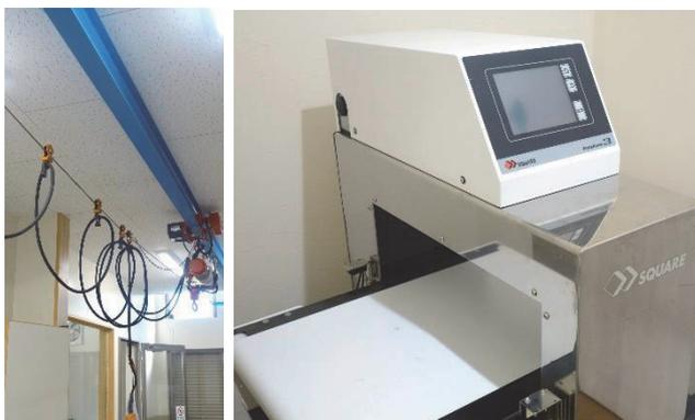
図 21 懸吊装置と金属探知機
