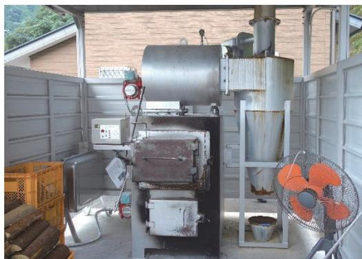
図 19 残渣用焼却炉
