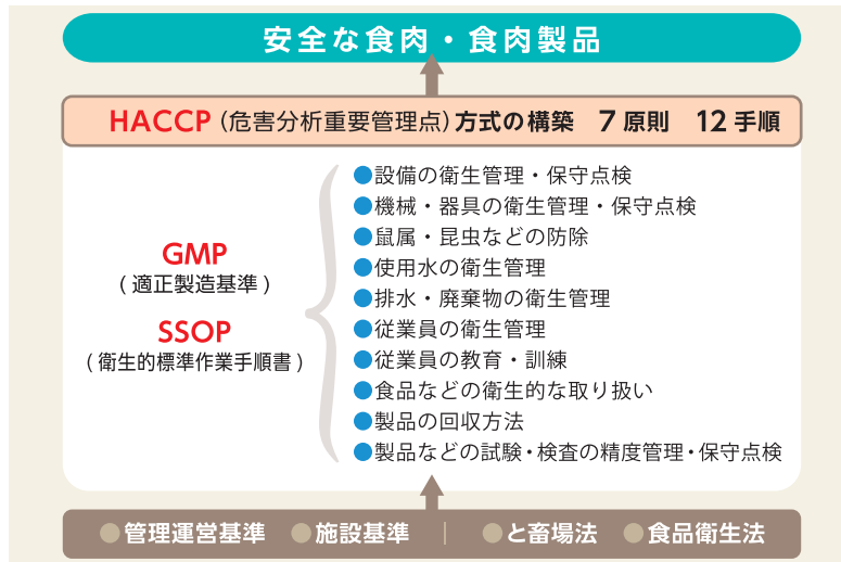
図表2 安全な食肉・食肉製品製造のための衛生管理システム
